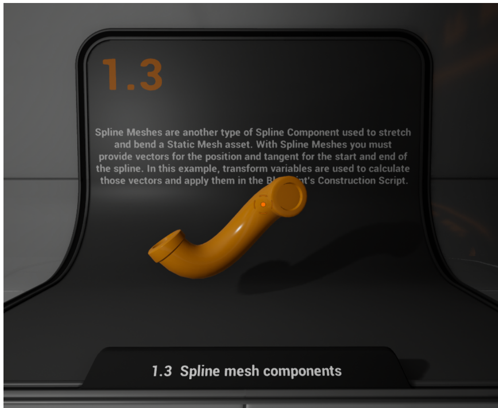
Abbildung 2.18 Spline Component Ein beliebiges Mesh kann entlang der Catmull-Rom-Spline verbogen und skaliert werden
